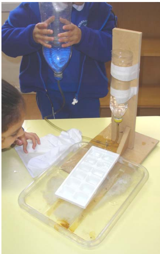
Figura 4 - Aparato usado no desafio. A garrafa presa ao suporte possui um furo na parte inferior por onde a água esguicha. Variando-se a altura da garrafa maior, varia-se o alcance do esguicho.
