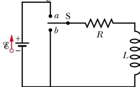
**19E.** Um solenóide de indutância igual a 6,30 μH está ligado em série a um resistor 1,20 kΩ. (a) Ligando-se uma bateria de 14,0 V a esse par, quanto tempo levará para que a corrente através do resistor atinja 80,0% de seu valor final? (b) Qual é a corrente através do resistor no instante t = 1,0 τ<sub>L</sub>?
